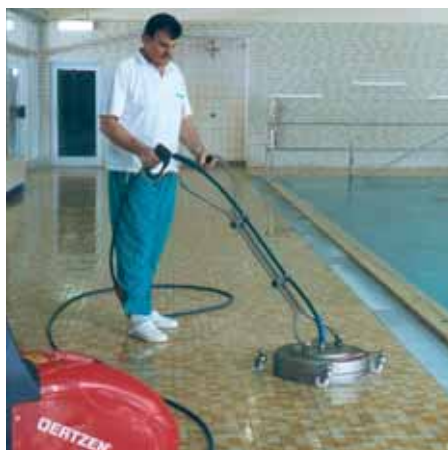
31er im Schwimmbad: spritzfreie HD-Reinigung mit Bodenreinigungswagen VA
